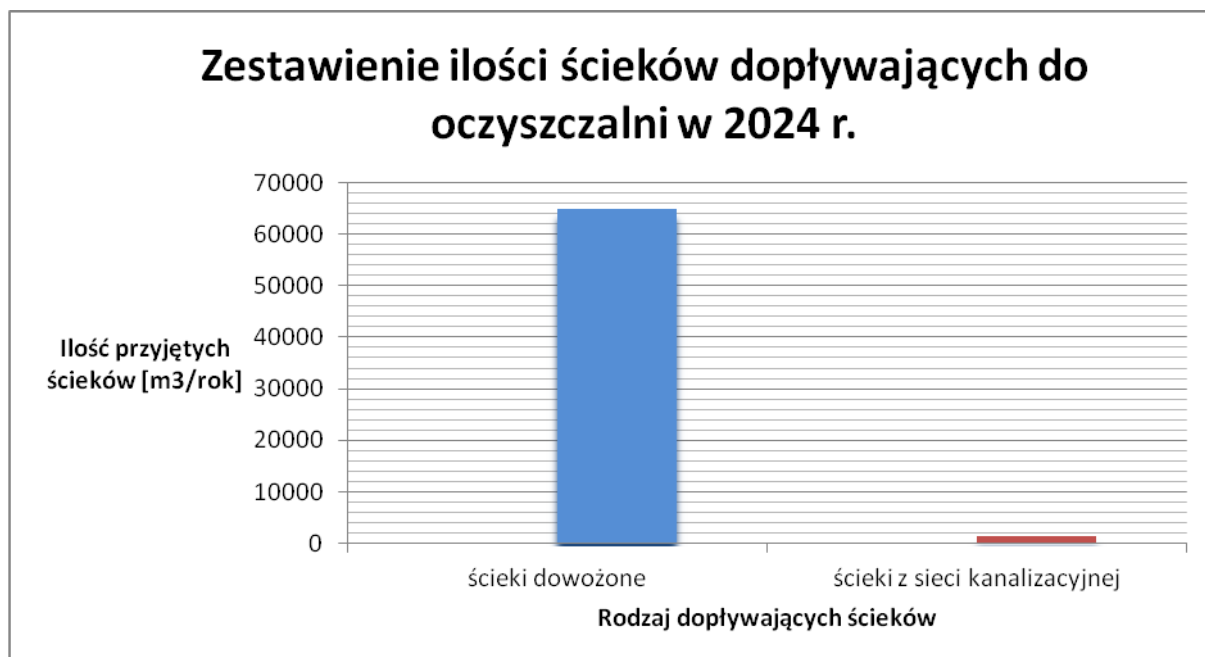
Wykres 8. Zestawienie ilości ścieków dowiezionych do oczyszczalni ścieków w Koziegłowach w 2024 r.z podziałem na ścieki dowożone oraz ścieki dopływające z sieci kanalizacyjnej.
