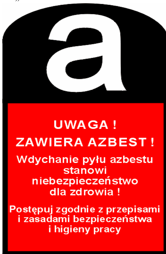
Rys. 14. Wzór oznakowania – pomieszczenie zawiera azbest
