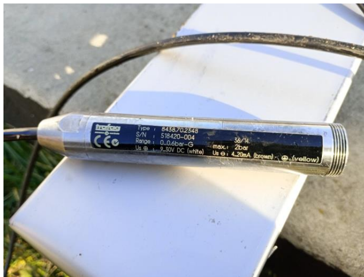
Uszkodzona sonda hydrostatyczna z pompowni głównej ścieków z wadliwym sensorem.
