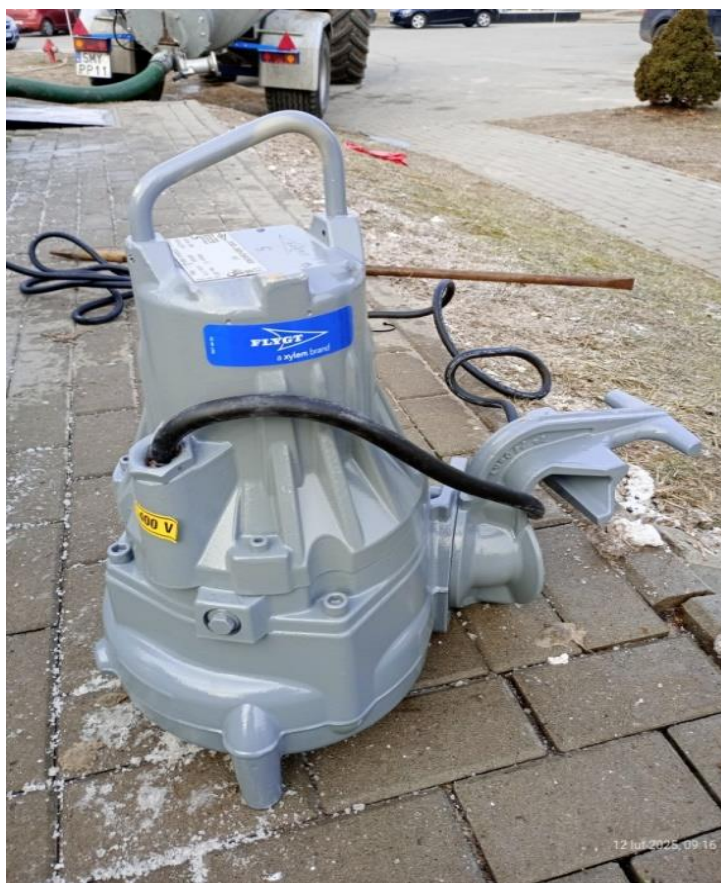
Strumienica Flygt 3085.160-2480900 zamontowana w pompowni zlewnej.
