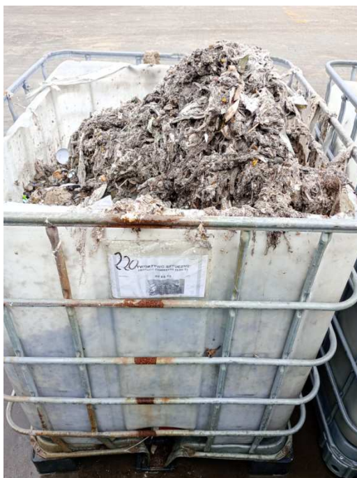
Zdj. Odpad z procesu mechanicznego oczyszczania ścieków: Skratki (kod odpadu: 19 08 01).
