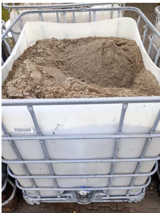
Zdj. Odpad z procesu mechanicznego oczyszczania ścieków: piasek z piaskowników (kod odpadu: 19 08 02).
