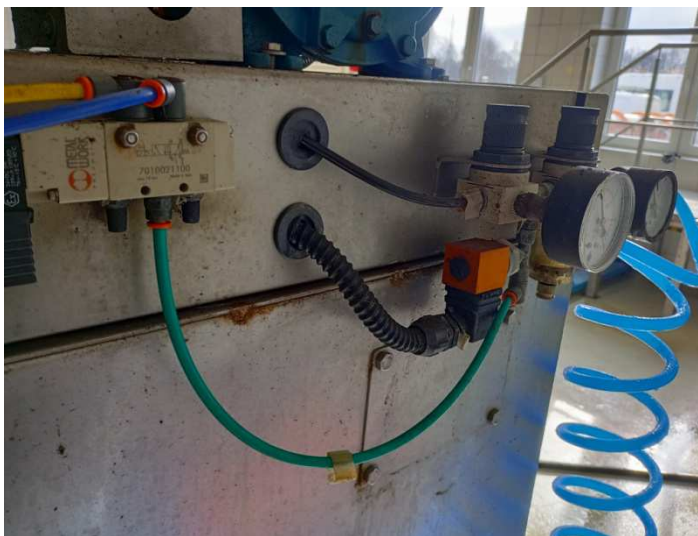
Zdj. Układ pneumatyczny prasy taśmowej Monobelt podczas pracy urządzenia, z manometrami wskazującymi ciśnienie robocze układu.
