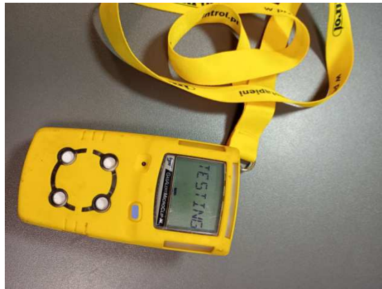
Zdj. Przenośny czujnik wielogazowy służący do detekcji siarkowodoru, gazów wybuchowych oraz monitorujący stężenie tlenu w powietrzu.
